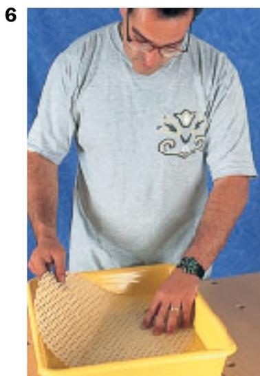
**6. Laisser tremper le cannage dans de l'eau claire à température ambiante jusqu'à ce qu'il se ramollisse. Le sortir et le laisser égoutter.**
