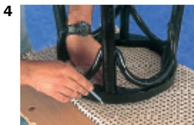
**4. Utiliser le siège pour tracer sa forme sur le cannage.**
