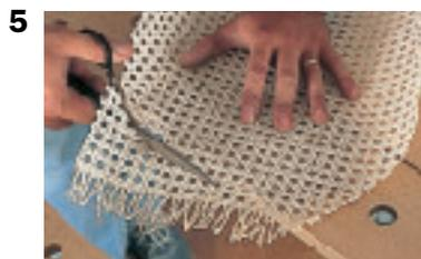
**5. Couper le cannage avec des ciseaux aux dimensions nécessaires : 1 cm de plus que l'extérieur de la gorge.**
